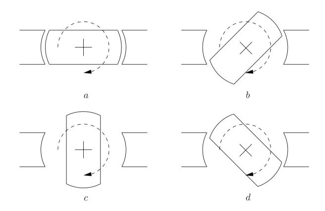
• Position a:  $L_{\max}$ ; Position c:  $L_{\min}$
